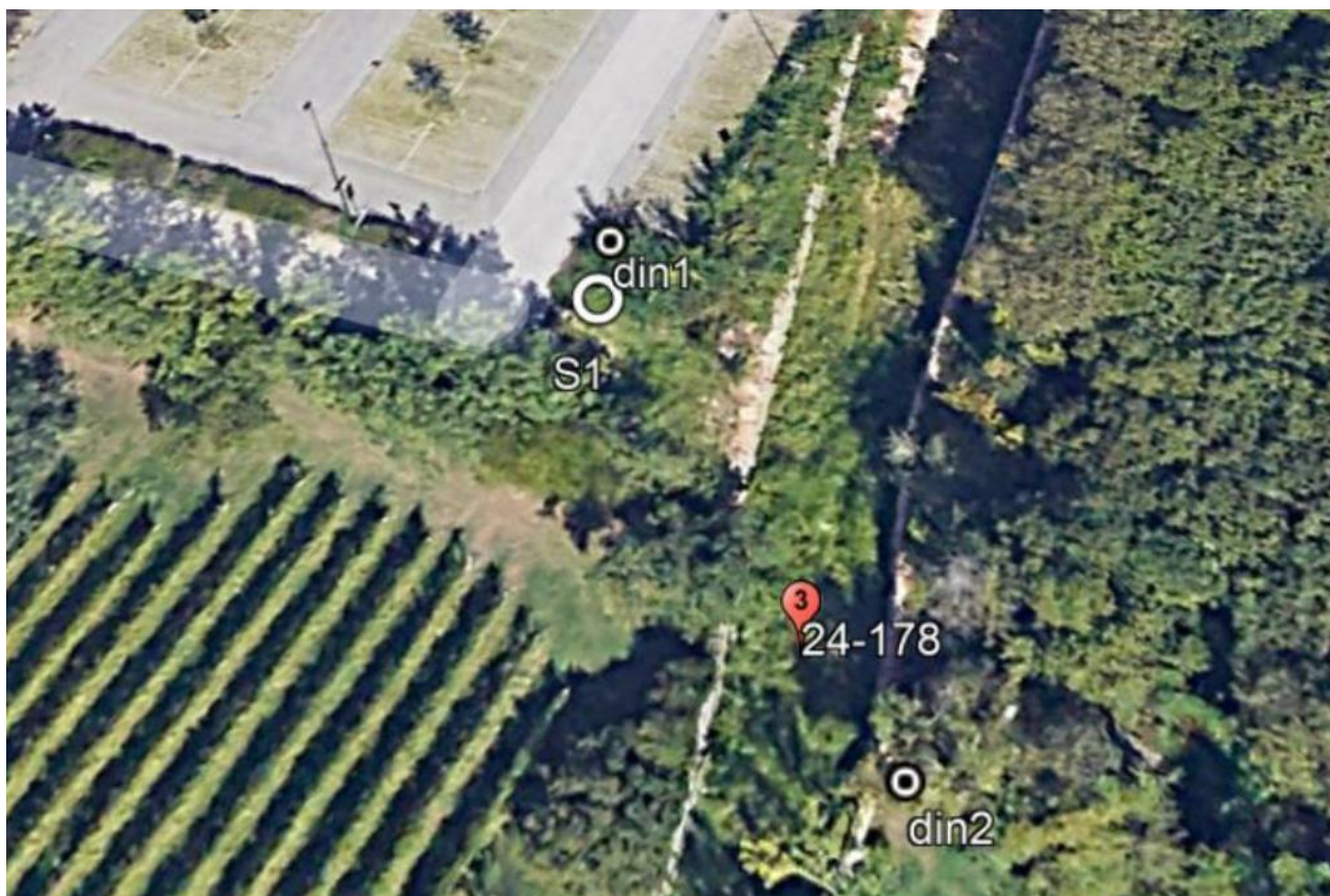
Figura 9 - posizionamento prove penetrometriche
